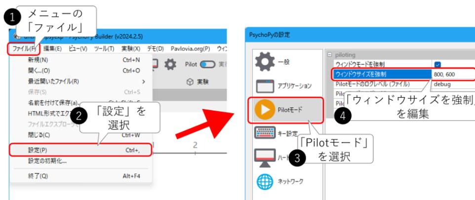
図 2.34 Pilot モードのウィンドウサイズの設定。Builder のメニューの「ファイル」から PsychoPy 設定ダイアログを開いて設定します。
