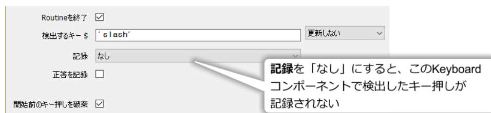
図 3.28 Keyboard コンポーネントで [記録] を「なし」に設定すると、その Keyboard コンポーネントで検出したキー押しが記録ファイルに出力されません。
