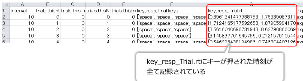
図 12.3 trial-by-trial 記録ファイルを確認すると、key_resp_Trial.rt にキーを押した時刻がすべて記録されています。このデータを用いて反応の頻度がどのように変化していくかを分析することが出来ます。
