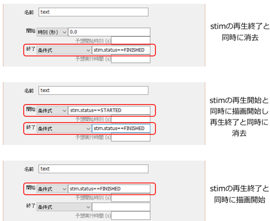
図 10.2 [開始] および [終了] に「条件式」を指定すると、条件式によってコンポーネントの開始、終了を制御できます
