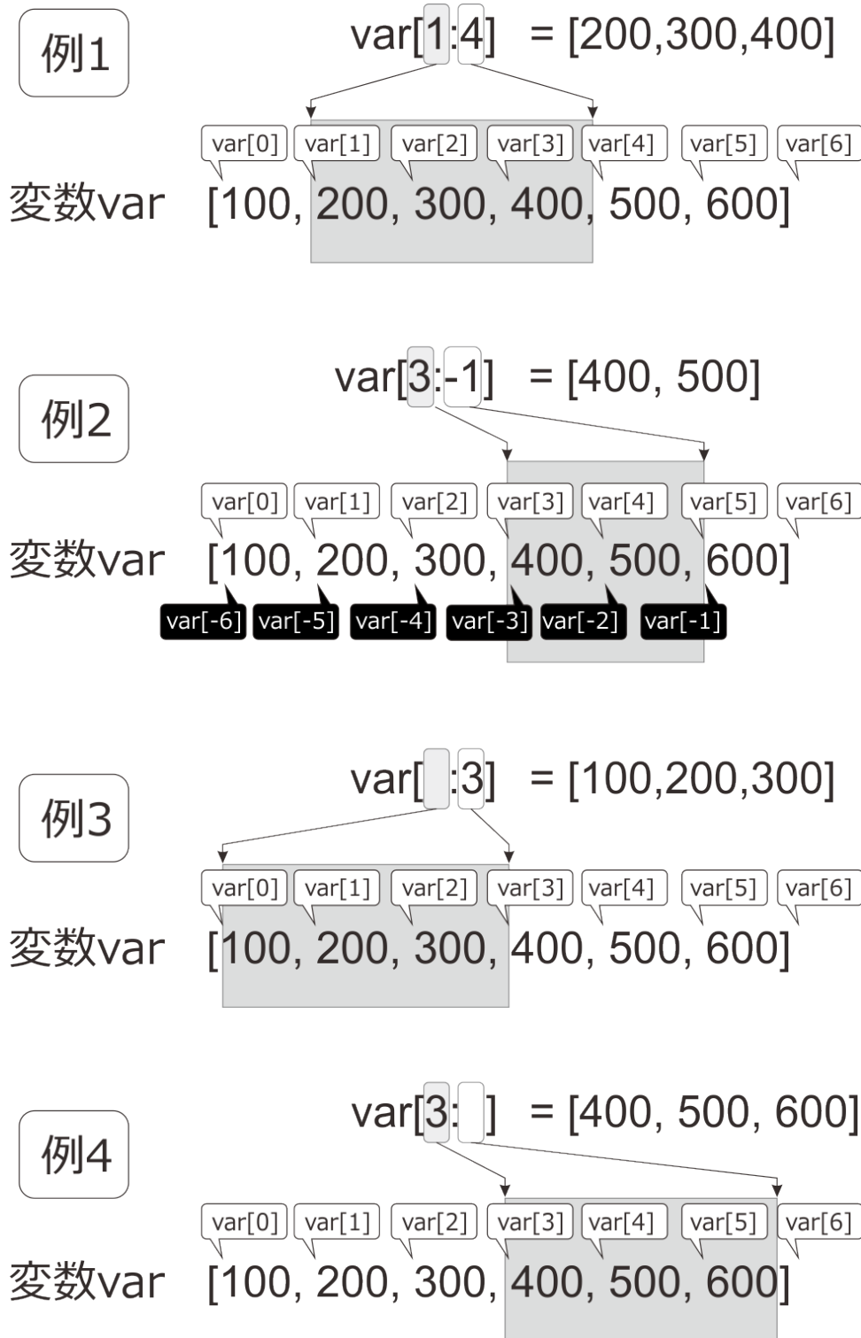
図 13.10 スライスによるリスト要素の抽出。var[a:b]と書くと、変数 var のインデックス a からインデックス b の間にある要素を抜き出します。a が省略されたときは先頭が、b が省略されたときは末尾が指定されたものとします。
